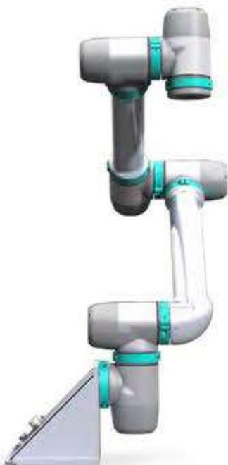
Le robot industriel modulaire 5 axes Robco-003 est un robot industriel léger.
