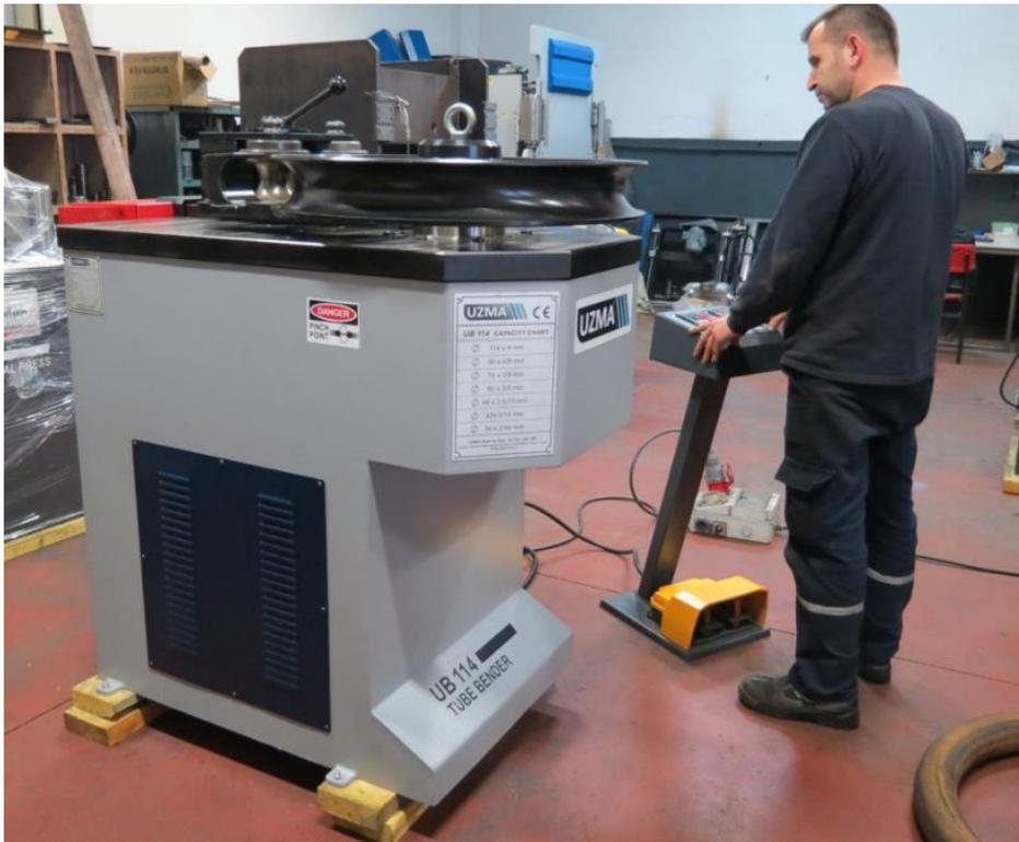
Les cintreuses par enroulement UZMA sont idéales pour le cintrage des tuyaux, les tubes, les carrés, les solides et autres profils.
